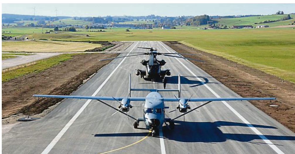
Ein Blick über die neue Start- und Landebahn am Heeresflugplatz Altenstadt. Vorne eine Maschine vom Typ M-28, dahinter Hubschrauber vom Typ CH-53. FOTO: HEROLD
